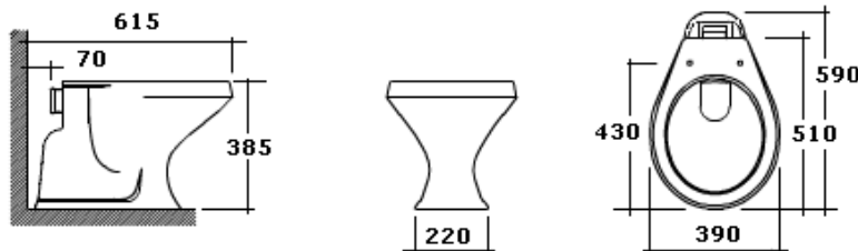
Bacia convencional Dimensões em milímetros
